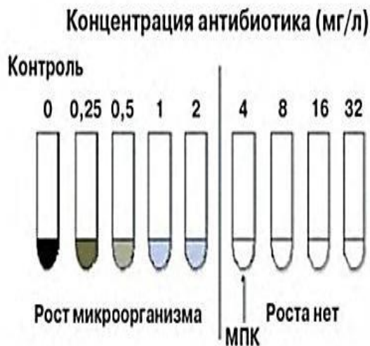
Рис. 8. Определение МПК методом серийных разведений (схема)
